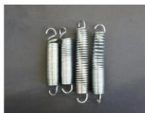
変形して危険な状態
